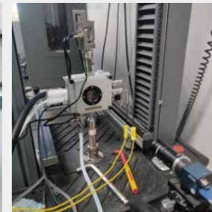
山东大学材料变温拉伸实验
